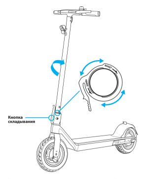
2. Зафиксируйте рулевую колонку с помощью механизма фиксации относительно заднего крыла.
